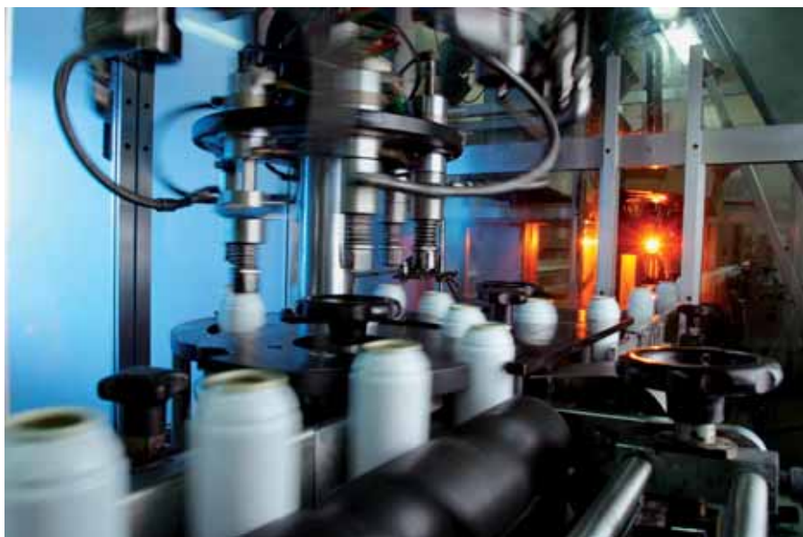
Установка для розлива напитков в банки – под контролем и управлением графических панелей оператора от компании Mitsubishi Electric.
