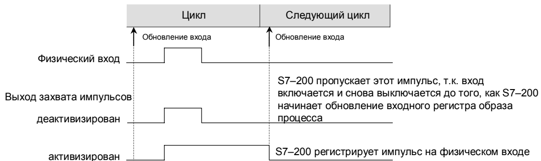
Рис. 4–27. Функционирование S7–200 с активизированным и деактивизированным захватом импульсов
