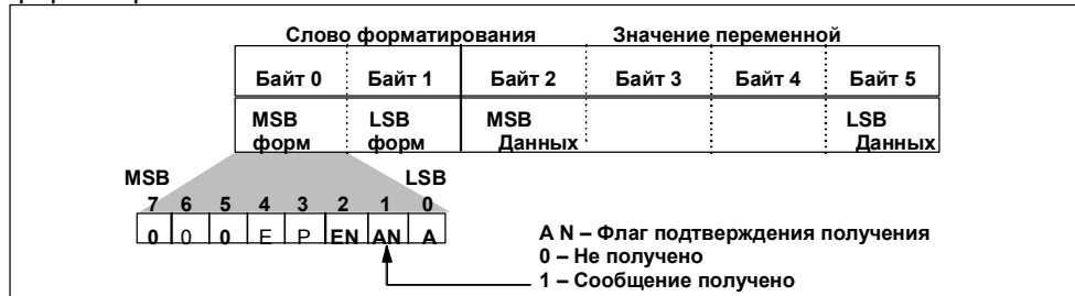
Рисунок D-12 Бит подтверждения получения сообщения в слове форматирования
