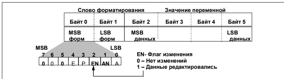
Рисунок D-14 Расположение флага редактирования в байте 0 слова форматирования
